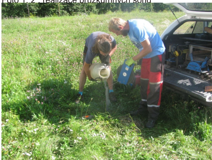
Foto 3 : realizace vsakovací zkoušky
